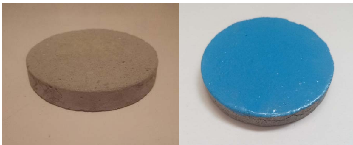
Рис. 1. – Бетонный образец без покрытия и покрытый эмалью
