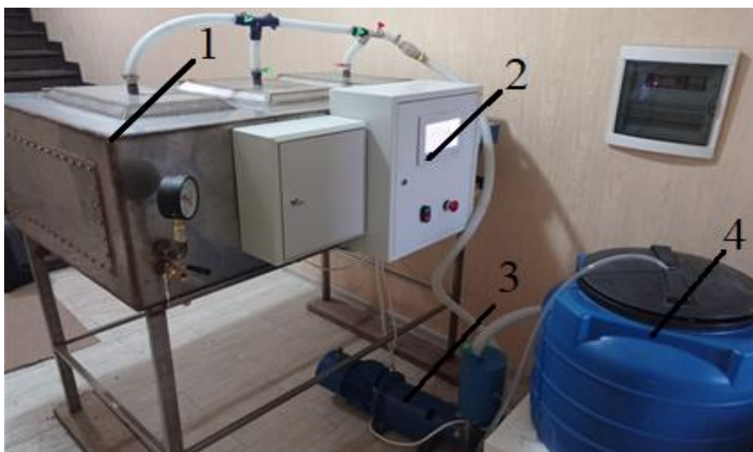
Рис. 1. – Общий вид инфракрасного сушильного аппарата камерного типа с пониженным внутрикамерным давлением. 1 – сушильная камера; 2 – ящик автоматизированного управления; 3 – водокольцевой вакуумный насос; 4 – резервуар с водой
