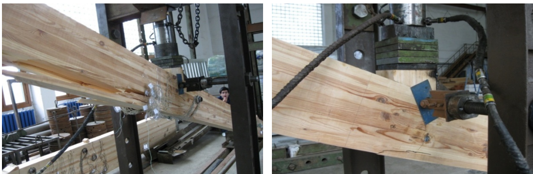
Рис. 3. – Общий вид поясов арки после испытаний
